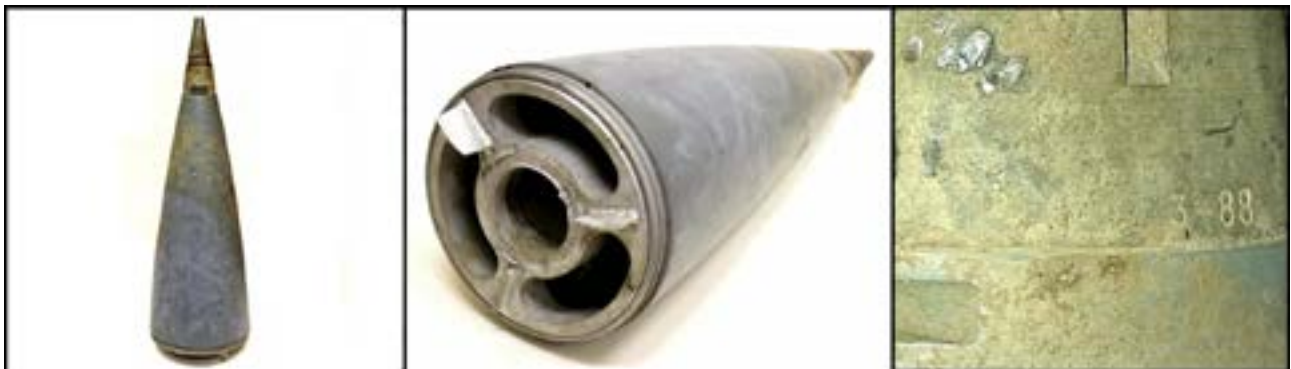
Носова частина з детонатором від реактивного снаряда РСЗО БМ-27 «Ураган» [50].
